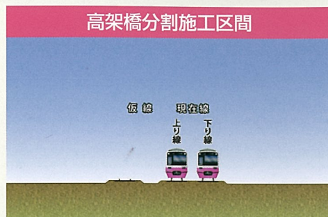
① 1線分の仮線用地を確保し仮線を敷設
