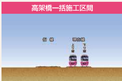
① 2線分の仮線用地を確保し仮線を敷設
