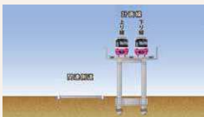
⑤ 計画上り線切替(全線高架化)・仮上り線撤去 ⑥ 一部に関連側道を整備
