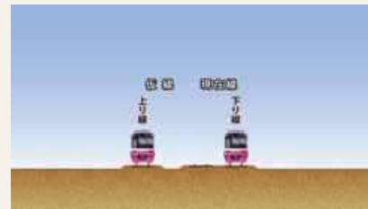
②-1 現在上り線を仮線に切替
